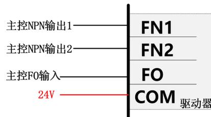
NPN 型故障输出时，COM 接 0V，FO 接 PLC 故障输入点
